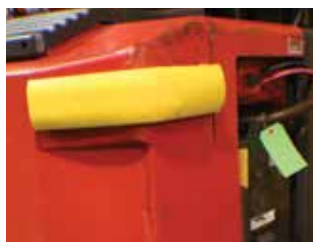
Grâce au ruban à double face adhésive, les surfaces non métalliques peuvent être protégées
