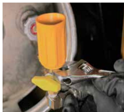
INSTALLER LE RACCORD SUR LE ROBINET POUR PROPANE AU MOYEN D'UNE CLÉ
